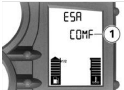
Die eingestellte Dämpfung wird im Multifunktionsdisplay im Bereich **1** angezeigt. Die Anzeigen haben folgende Bedeutung:
