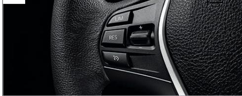
**[ 01 ]** Die Multifunktion für das Lenkrad erlaubt ausstattungsabhängig die Steuerung von Telefon-, Sprach- und Audiofunktionen sowie der Speed Limit Funktion per Lenkradlasten.
