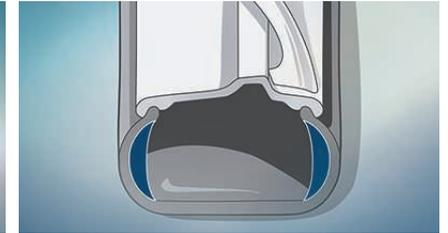
■ **Reifendruckanzeige.** Sensoren an jedem Rad erfassen Reifendruck und -temperatur, und die Reifendruckanzeige warnt den Fahrer bei einem Druckverlust.
