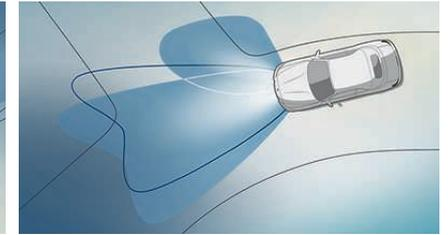
□ **Adaptives Kurvenlicht** mit variabler Lichtsteuerung bietet in jeder Situation eine optimale Ausleuchtung und steigert somit die aktive Fahrsicherheit.
