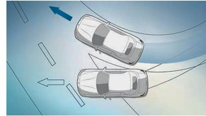
■ **Dynamische Stabilitäts Control (DSC)** erkennt Schleuderneigung und stabilisiert das Fahrzeug.
