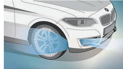
■ **Air Curtain** kanalisiert den Fahrtwind an Frontschürze und Vorderrädern, verringert so Turbulenzen, den Luftwiderstand und den Kraftstoffverbrauch.
