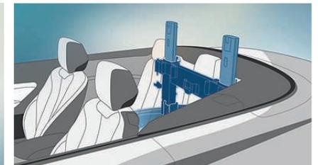
■ **Vollversenktes Überrollschutzsystem** schützt die Insassen im Cabrio bei einem Fahrzeugüberschlag durch automatisch ausfahrende Überrollbügel.
