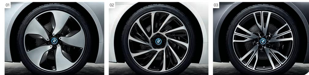
**Groß, sportlich und effizient:** Die bereits serienmäßig mit 20 Zoll Durchmesser sehr groß dimensionierten BMW i Leichtmetallräder Turbinenstyling 444 mit Mischbereifung, BMW EfficientDynamics sind in Relation zum Durchmesser besonders schmal, flächig und geschlossen ausgeführt, um den Luft- und Rollwiderstand so weit wie möglich zu reduzieren. Auf der anderen Seite sind sie so breit wie nötig, um die Leistung des
