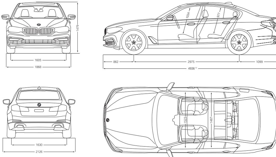
Alle Maßangaben der technischen Zeichnung in Millimeter. Höhe ohne Dachantenne beträgt 1466 mm. Angaben zu Fahrleistung, Verbrauch und CO<sub>2</sub>-Emission gelten für Fahrzeuge mit Seriengetriebe.
