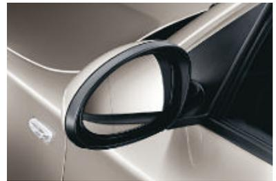
■ **Außenspiegel**, in Wagenfarbe lackiert und elektrisch verstellbar. Darüber hinaus sind die Spiegel asphärisch und für die Modelle 125i, 135i und 123d beheizt.
