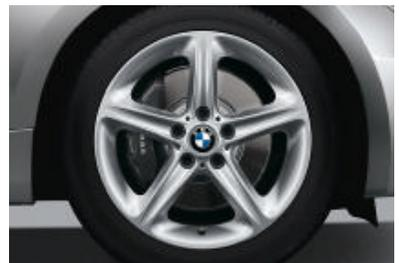
□ **BMW Leichtmetallräder Sternspeiche 264** mit Mischbereifung und Notlaufeigenschaften, vorn 7,5 J x 18 Zoll mit Bereifung 215/40 R 18, hinten 8,5 J x 18 Zoll mit Bereifung 245/35 R 18 (Serie für 135i).
