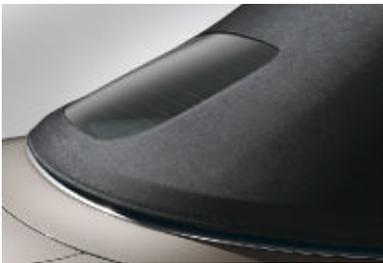
■ **Verdeck**, mehrlagig gefüttert, passt sich harmonisch der Formgebung des Cabrios an (hier abgebildet in der optionalen Ausführung Anthrazit mit Silbereffekt). Der Innenraum wird wirksam gegen Geräusche und extreme Temperaturen gedämmt.
