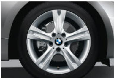
□ **BMW Leichtmetallräder Sternspeiche 262** mit Mischbereifung und Notlaufeigenschaften, vorn 7 J x 17 Zoll mit Bereifung 205/50 R 17, hinten 7,5 J x 17 Zoll mit Bereifung 225/45 R 17 (nicht für 135i).
