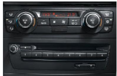
□ **Klimaautomatik** (hier abgebildet), inkl. AUC, Mikrofilter, Beschlag- und Solarsensor sowie Restwärmetaste; hält Temperatur konstant (getrennte Einstellung rechts/links). Zusätzlich: spezieller Cabrioklimamodus.
