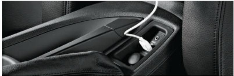
■ **AUX-IN Anschluss**, inkl. 12-V-Steckdose, zum Anschluss einer externen Audioquelle, z. B. eines MP3-Players.
