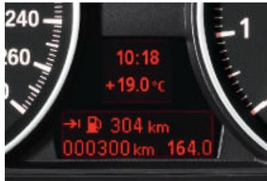
■ **Bordcomputer** informiert über Durchschnittsgeschwindigkeit, Durchschnitts- und Momentanverbrauch, Reichweite und Außentemperatur. Er verfügt außerdem über eine akustische Eiswarnung.
