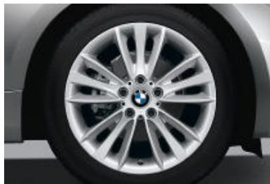
□ **BMW Leichtmetallräder W-Speiche 263** mit Mischbereifung und Notlaufeigenschaften, vorn 7,5 J x 18 Zoll mit Bereifung 215/40 R 18, hinten 8,5 J x 18 Zoll mit Bereifung 245/35 R 18.
