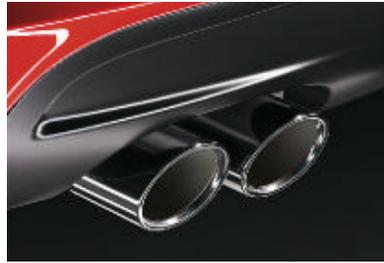
■ **Doppelabgasendrohr:** Die Abgasanlage mit zwei schwarz verchromten Auspuffendrohren ist beim 135i serienmäßig.
