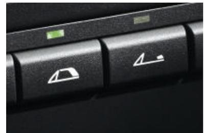
■ **Verdeckbetätigungstaste** für vollautomatisches Öffnen und Schließen des Verdecks. Der Öffnungsvorgang kann bei Geschwindigkeiten von bis zu 40 km/h aktiviert werden und wird bis 50 km/h fortgesetzt.
