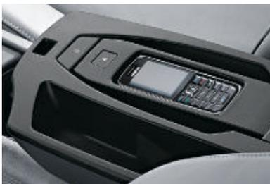
□ **Handyvorbereitung Business mit Bluetooth-Schnittstelle**, inkl. BMW Assist (inkl. Freisprecheinrichtung, Anschluss für Lademöglichkeit und Außenantenne). Über einen separat erhältlichen Snap-In-Adapter kann ein Bluetooth-fähiges Handy angeschlossen werden, das sich auch via iDrive (in Verbindung mit Navigationssystem) bedienen lässt.
