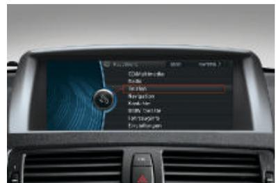
□ **Navigationssystem Professional**, inkl. Radio Professional mit DVD-Laufwerk, iDrive Controller mit Direktwahltasten, acht Favoritentasten, integrierte Festplatte für Kartenmaterial und Audiodateien, feststehendem und hochauflösendem 8,8-Zoll-Grafikdisplay, Karten- oder 3-D-Routendarstellung, Birdview.
