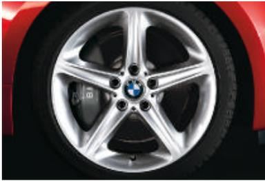
■ **Hochleistungsbremsen, lackiert, mit BMW Schriftzug:** mit vorn und hinten innenbelüfteten 17-Zoll-Bremsscheiben. Sorgen für sehr kurze Bremswege und höchste Standfestigkeit.
