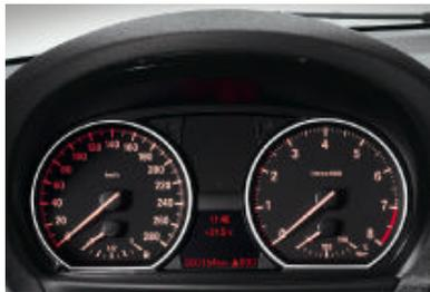
■ **Instrumententafel** mit Analoginstrumenten und roter Durchlichtbeleuchtung für Tacho und Drehzahlmesser sowie Bordcomputer mit LC-Display für Kilometer- und Tageskilometerzähler.
