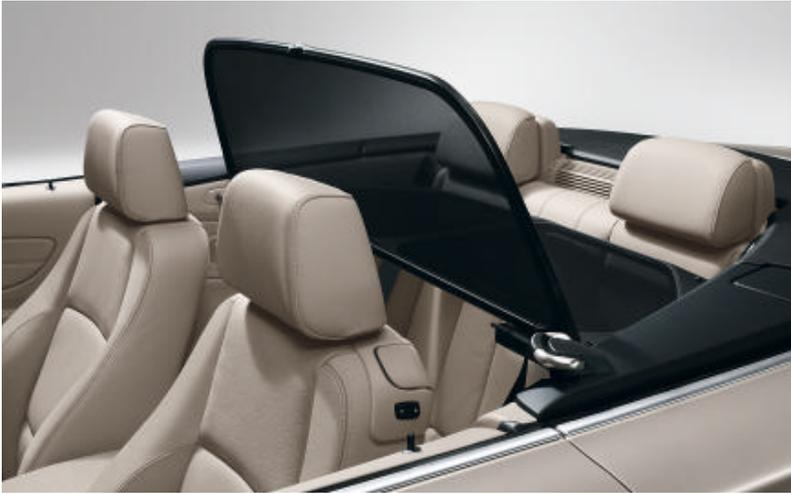
□ **Windschutz** ermöglicht genussvolles Offenfahren ohne Zugluft und störende Verwirbelungen im Schulter- und Nackenbereich; der Windschutz lässt sich einfach bedienen, ist klappbar und kann platzsparend im Gepäckraum verstaut werden.
