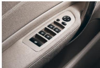
■ **Fensterheber, elektrisch**, Zug-Druckschalter und Maufunktion „Auf-Zu“, Komfortschließen und Einklemmschutz; Zentralschalter zum gleichzeitigen Öffnen und Schließen aller Fenster.
