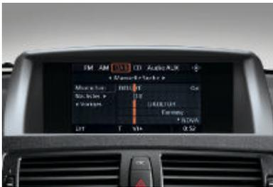
□ **DAB-Tuner** zum zusätzlichen Empfang digitaler Radioprogramme (nur in Verbindung mit Navigationssystem oder Radio Professional – hier dargestellt am Navigationssystem Business).
