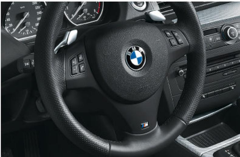
□ **Schaltwippen am Sportlenkrad** (in Verbindung mit 6-Gang-Automatic) ermöglichen das schnelle, manuelle Wechseln der Gänge, ohne zu kuppeln (hier abgebildet mit M Lederlenkrad und Interieurleisten in Aluminium Glaciersilber).
