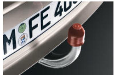
□ **Anhängerkupplung** mit abnehmbarem Kugelkopf (nicht erhältlich für 135i).
