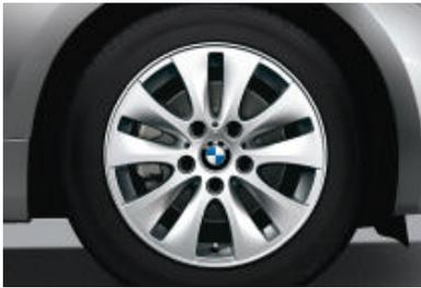
■ **BMW Leichtmetallräder V-Speiche 229<sup>1</sup>**, 6,5 J x 16 Zoll, Bereifung 195/55 R 16 (Serie 118i); 7 J x 16 Zoll, Bereifung 205/55 R 16 (erhältlich für 120i und 120d, nicht erhältlich für 125i, 135i und 123d).
