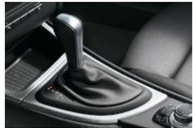
□ **6-Gang-Automatic Getriebe** (Abbildung mit Nichtraucherpaket) mit Adaptiver Getriebe-steuerung (AGS) und Steptronic. Die Schaltung ermöglicht sehr schnelle und absolut fehlerfreie Gangwechsel – für ein Höchstmaß an Fahrdynamik (im 135i nur mit Schaltwippen am Lenkrad).
