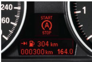
■ **Auto Start Stop Anzeige** signalisiert im Info Display, wenn der Motor über die Auto Start Stop Funktion abgeschaltet ist (z. B. vor einer Ampel oder bei einem Stau). Beim nächsten Betätigen der Kupplung startet der Motor automatisch, und die Anzeige erlischt wieder (für Vierzylinder-Modelle in Verbindung mit 6-Gang-Schaltgetriebe).
