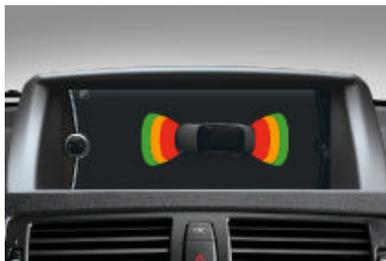
□ **Park Distance Control (PDC)\***, erhältlich für vorn und hinten sowie nur für hinten, erleichtert das Einparken und Rangieren auf engstem Raum; die Entfernung von Ihrem Fahrzeug zu einem Hindernis wird akustisch und in Verbindung mit einem optionalen Navigationssystem auch optisch im Control Display gemeldet.
