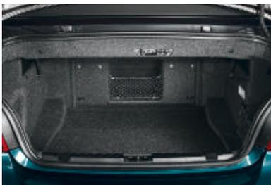
■ **Gepäckraum**, mit einem Volumen von 260 Liter (geöffnetes Verdeck) bis 305 Liter (geschlossenes Verdeck); der Gepäckraum ist mit Textil ausgekleidet, beleuchtet und verfügt zusätzlich über vier Verzurrösen, einen Gummizug (links) sowie ein Ablagefach mit verschiebbarem Netz an der Rücksitzbanklehne (nicht erhältlich in Verbindung mit der Sonderausstattung Durchlade).
