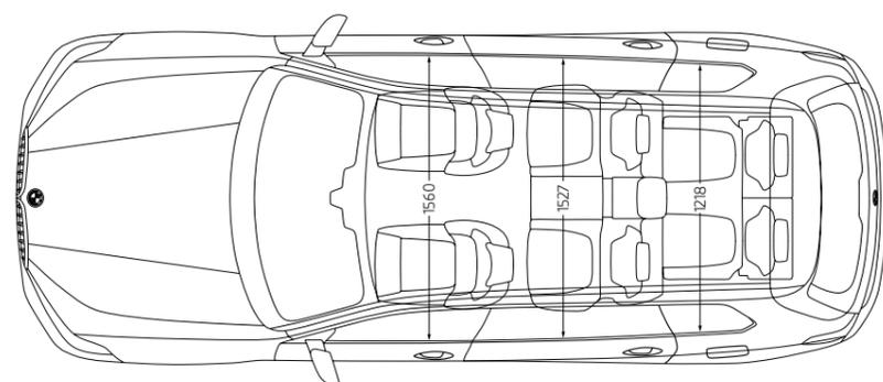
Alle Maßangaben der technischen Zeichnung in Millimeter. Höhe ohne Dachantenne beträgt 1466 mm. Angaben zu Fahrleistung, Verbrauch und CO<sub>2</sub>-Emissionen gelten für Fahrzeuge mit Seriengeräte.
