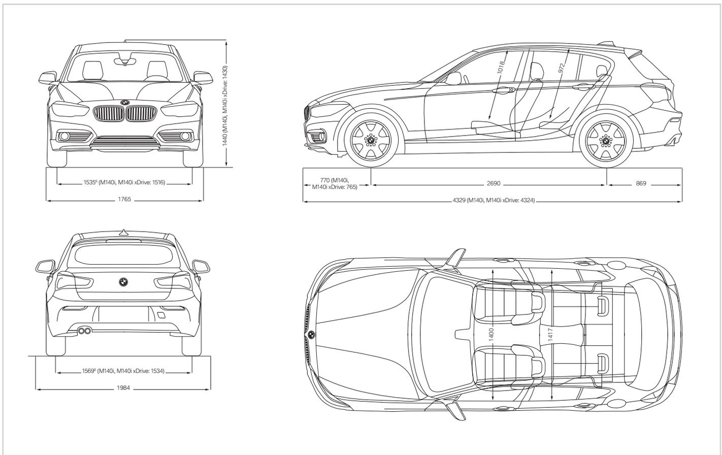
Alle Maßangaben der technischen Zeichnungen in Millimeter (hier gezeigt am BMW 1er 5-Türer). Die Innenraummaße des BMW 1er 3-Türer weichen teilweise ab. Angaben zu Fahrleistung, Verbrauch und CO<sub>2</sub>-Emission gelten für Fahrzeuge mit Seriengeräte. Werte in [ ] gelten für Fahrzeuge mit Steptronic Getriebe.
