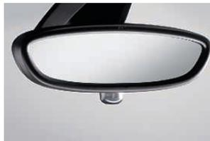
□ **Innenspiegel**, automatisch abdblendend, große Spiegelfläche; ab einem definierten Lichteinfall durch nachfolgende Fahrzeuge blendet der Spiegel automatisch ab.
