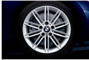
**17" M Leichtmetallräderr Doppel spoke 207 M** mit Mischbereifung und Notlaufeigenschaften: vorn 7 J x 17 mit Bereifung 205/50 R 17, hinten 7,5 J x 17 mit Bereifung 225/45 R 17.
