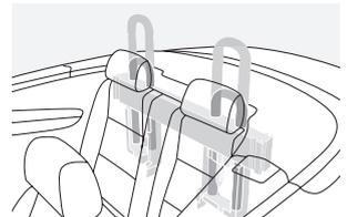
■ **Überrollschutzesystem** gewährt bei einem Unfall größtmöglichen Insassenschutz. Bei Überschreiten definierter Grenzwerte der Fahrzeugneigung, der Längs- oder Querschleunigung oder bei Verlust des Bodenkontaktes schnellen die hinter den Fondkopfstützen integrierten Überrollbügel sensorgesteuert innerhalb von Sekundenbruchteilen hoch.
