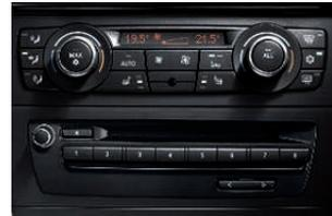
□ **Klimaautomatik** (hier abgebildet), inkl. AUC, Mikrofilter, Beschlag- und Solarsensor sowie ALL-Taste; hält die Temperatur konstant (getrennte Einstellung rechts/links).
