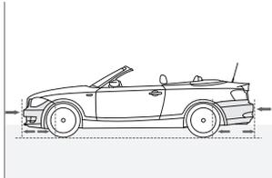
■ **Stoßfänger** verkraften Stöße bis 4 km/h schadlos. Spezielle Deformationselemente vorn und hinten nehmen Kräfte bis 15 km/h auf.
