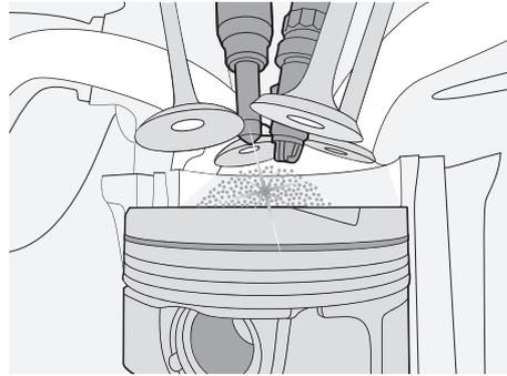
**High Precision Injection:** Bei den Vierzylinder-Motoren im 118i und 120i ermöglichen die in unmittelbarer Nähe zur Zündkerze angeordneten Piezoinjektoren einen mageren Betrieb im Teillastbereich. Sie spritzen den Kraftstoff für eine optimale Verbrennung innerhalb eines Wimperschlags bis zu 200-mal mit hohem Druck in die Zylinder. Dabei wird nur ein Teil des Brennraums mit einem zündfähigen Benzin-Luft-Gemisch gefüllt und ein besonders effizienter Kraftstoffverbrauch erreicht.
