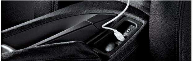
■ **AUX-IN Anschluss**, inkl. 12-V-Steckdose, zum Anschluss einer externen Audioquelle, z. B. eines MP3-Players.
