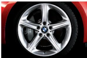
■ **Hochleistungsbremsen, lackiert, mit BMW Schriftzug:** mit vorn und hinten innenbelüfteten 17"-Brems Scheiben. Sorgen für sehr kurze Bremswege und höchste Standfestigkeit.
