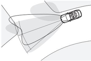
□ **Adaptives Kurvenlicht mit variabler Lichtverteilung, inkl. Abbiegelicht**, leuchtet Kurven durch eine elektromechanische Steuerung der beweglichen Scheinwerfer optimal aus, sobald der Fahrer in sie einlenkt.
