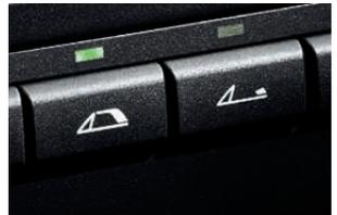
■ **Verdeckbetätigungstaste** für vollautomatisches Öffnen und Schließen des Verdeckes. Der Öffnungsvorgang kann bei Geschwindigkeiten von bis zu 40 km/h aktiviert werden und wird bis 50 km/h fortgesetzt.
