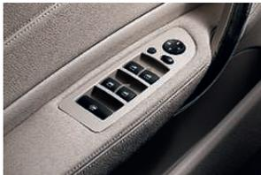
■ **Fensterheber, elektrisch**, Zug-Druckschalter und Mautfunktion „Auf-Zu“; Komfortschließung und Einklemmschutz; Zentralschalter zum gleichzeitigen Öffnen und Schließen aller Fenster.
