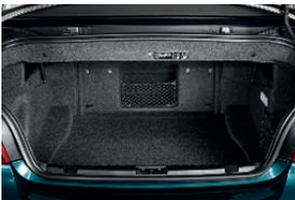
■ **Gepäckraum** mit einem Volumen von 260 Litern (geöffnetes Verdeck) bis 305 Litern (geschlossenes Verdeck); der Gepäckraum ist mit Textil ausgekleidet, beleuchtet und verfügt zusätzlich über vier Verzurrösen, einen Gummizug (links) sowie ein Ablagefach mit verschiebbarem Netz an der Rücksitzbanklehne (nicht erhältlich in Verbindung mit der Sonderausstattung Durchlade).
