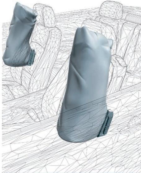
Schützen, ohne zu stören: Hinter den Fondkopfstützen sind zwei Überrollbügel integriert.
