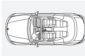
■ **Airbags:** In einem BMW sind alle Sicherheitskomponenten optimal aufeinander abgestimmt. Vier Airbags bieten gezielten Schutz: Fahrer- und Beifahrerairbag sowie die in den Vordersitzlehnen integrierten Kopf-Thorax-Airbags.
