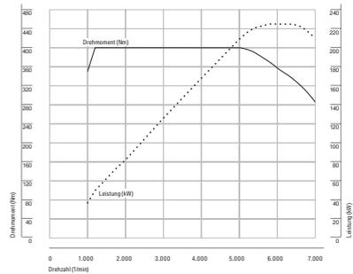
**Drehmomentstärke, die begeistert. Das BMW TwinPower Turbo Reihen-Sechszylinder-Triebwerk im BMW 135i bietet bereits ab 1.200/min ein ungemein kraftvolles Drehmoment von 400 Nm.**
