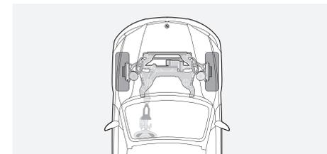
**Aluminium-Vorderachse:** Doppelgelenk-Zugstrebenachse in Leichtbauweise. Für maximale Steifigkeit bei minimalem Gewicht. Mit Hydro-Motorlagerung für hervorragenden Schwingungs- und Akustikkomfort. Gesamtergebnis: einzigartige Fahrdynamik, unvergleichliche Lenkcharakteristik.
