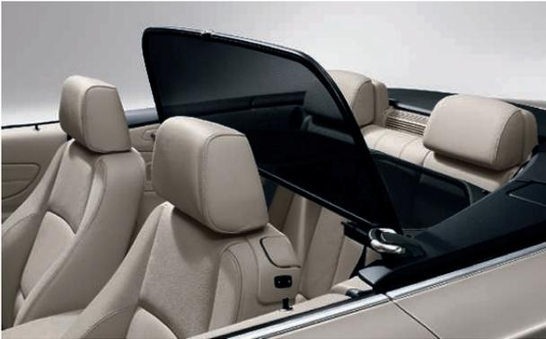
□ **Windschutz** ermöglicht genussvolles Offenfahren ohne Zugluft und störende Verwirbelungen im Schulter- und Nackenbereich; der Windschutz lässt sich einfach bedienen, ist klappbar und kann platzsparend im Gepäckraum verstaut werden.
