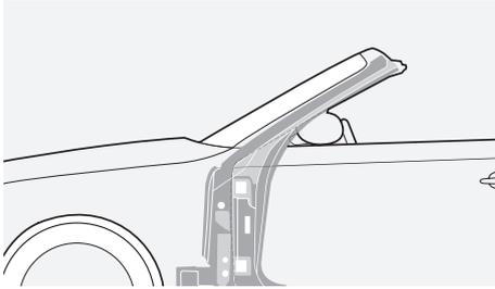
In der Fahrgastzelle übernimmt der im Bereich von A-Säule und Windlauf verstärkte Scheibenrahmen die Funktion eines Überrollbügels.
