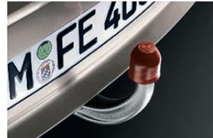
□ **Anhängerkupplung mit abnehmbarem Kugelkopf** (nicht erhältlich für 135i).
