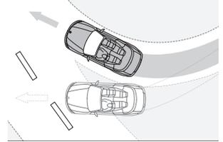
■ **Dynamische Stabilitäts Control (DSC)**, inkl. CBC und Zusatzfunktionen – z. B. Bremsassistent – für 125i und 135i. DSC erkennt eine Schleuderneigung im Ansatz und stabilisiert das Fahrzeug in Millisekunden. Die Unterfunktion Traktionsmodus (DTC) erlaubt erhöhten Radschlupf, um situationsabhängig den Vortrieb zu optimieren und sportlicheres Fahren zu ermöglichen.
