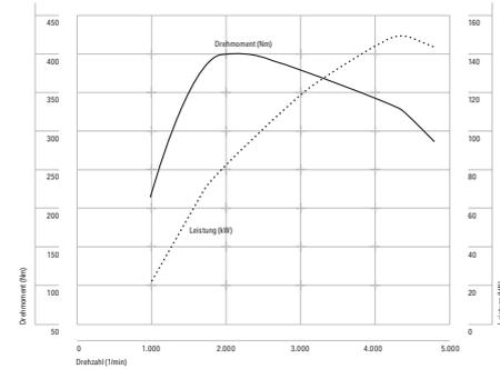
**Kraftpaket:** Der BMW TwinPower Turbo Vierzylinder-Diesel im BMW 123d bietet dank Variable Twin Turbo bereits bei 2.000/min sein maximales Drehmoment von 400 Nm.
