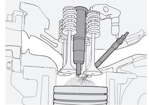
**Bei der Dieseldirekteinspritzung** wird der Kraftstoff über elektrisch angesteuerte Injektoren in den Brennraum des Motors injiziert. Der Einspritzzeitpunkt ist frei wählbar bei bis zu fünf Einspritzvorgängen je Verbrennungszyklus – dadurch werden die Akustik und das Emissionsverhalten des Motors deutlich verbessert.
