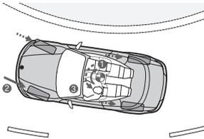
■ **Cornering Brake Control (CBC)** erhöht die Fahrstabilität beim leichten Bremsen in schnell gefahrenen Kurven. Die hinteren Räder werden beim Bremsen entlastet, was zum Eindrehen des Fahrzeugs führen kann (1). CBC wirkt dem entgegen, indem es beim Bremsen außerhalb des ABS-Regelbereiches durch asymmetrische Regelung des Bremsdrucks (2) ein stabilisierendes Gegenmoment erzeugt (3).
