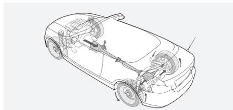
**Hinterradantrieb:** Der BMW typische Hinterradantrieb sorgt für ein besonders agiles Fahrzeug-Handling. Es zeichnet sich aus durch einen geringen Wendekreis, hohe Spurtreue, ein dynamisches Kurvenverhalten und beste Traction in allen Situationen.
