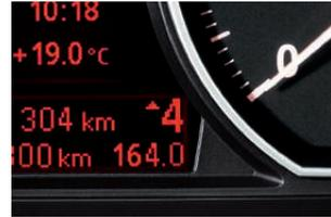
■ **Schaltpunktanzeige** zeigt an, wenn Sie in einem anderen Gang verbrauchsgünstiger fahren würden. Das System gibt Empfehlungen zum Hoch- oder Zurückschalten und passt diese Ihrem Fahrstil an. Beim Beschleunigen z. B. bekommen Sie den nächsten Schaltniveau, wenn Sie in einem höheren Gang genauso weiterbeschleunigen, dabei aber Kraftstoff sparen (für Fahrzeuge mit 6-Gang Schaltgetriebe).
