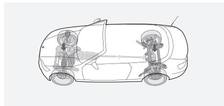
**50:50-Gewichtsverteilung:** Nahezu die Hälfte des Gewichts vorn und hinten – dieses Prinzip sorgt für das gewünschte neutrale Eigenlenkverhalten. Zusammen mit dem erstklassigen Fahrwerk und serienmäßigem DSC ergibt sich ein Höchstmaß an Handlichkeit und Souveränität in jeder Fahrsituation.
