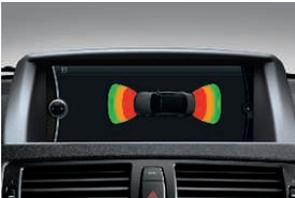
□ **Park Distance Control (PDC)**<sup>1</sup>, erhältlich für vorn und hinten sowie nur für hinten, erleichtert das Einparken und Rangieren auf engstem Raum; die Entfernung von Ihrem Fahrzeug zu einem Hindernis wird akustisch und in Verbindung mit einem optionalen Navigationssystem auch optisch im Control Display gemeldet.
