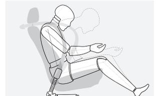
■ **BMW Rückhaltesystem** für Fahrer und Beifahrer; die Kombination aus 3-Punkt-Sicherheitsgurt, pyrotechnischem Gurtstrammer und Gurtkraftbegrenzer sorgt für bestmögliche Rückhaltewirkung bei einer Kollision.
