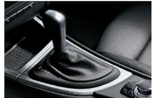
□ **6-Gang Automatic Getriebe Steptronic** (Abbildung mit Nichtraucherpaket) mit Adaptiver Getriebesteuerung (AGS). Die Schaltung ermöglicht sehr schnelle und absolut fehlerfreie Gangwechsel – für ein Höchstmaß an Fahrdynamik (nicht für 135i).
