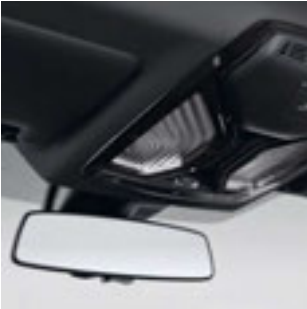
■ Der automatisch abdunkelnde Innenspiegel vermindert unangenehmes Blenden durch das Scheinwerferlicht nachfolgender Fahrzeuge.
