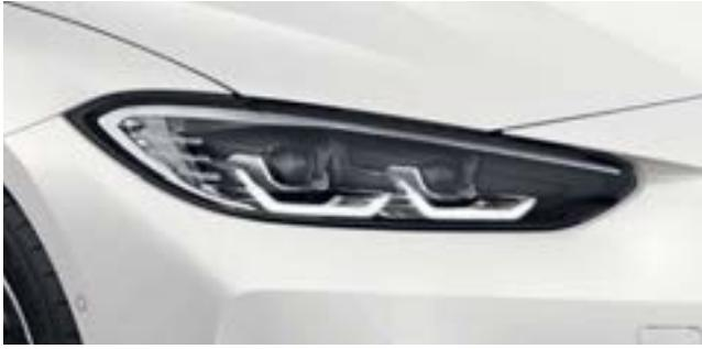
■ Die Scheinwerfer mit Fahrtrichtungsanzeiger, Stand- und Tagfahrlicht in LED-Technik sowie Abblend- und Fernlicht in Bi-LED-Technik sind besonders langlebig und energiesparend. Die LED-Scheinwerfer verfügen zudem über eine automatische Leuchtweitenregulierung und erhöhen mit einer hervorragenden Ausleuchtung und tageslichtähnlicher Lichtfarbe die Sicherheit bei Nacht und schlechter Witterung.
