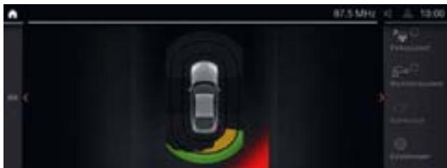
■ Der Parkassistent inkl. Rückfahrkamera<sup>1</sup> parkt das Fahrzeug selbstständig in Quer- und Längsparklücken ein sowie aus Längsparklücken wieder aus. Er wird über den Parktaster oder durch Einlegen des Rückwärtsgangs aufgerufen. Alle Lenk-, Fahr- und Bremsvorgänge werden vom System übernommen, Sie müssen den Parkvorgang lediglich überwachen.
