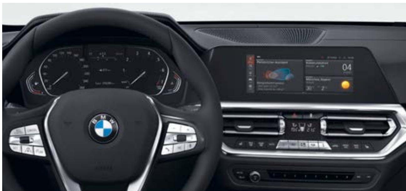
■ Das BMW Live Cockpit Plus beinhaltet u. a. eine 5,1" große Instrumentenkombination im Instrumentenpanel und ein hochauflösendes touchfähiges Control Display mit 8,8" Bildschirmdiagonale.
