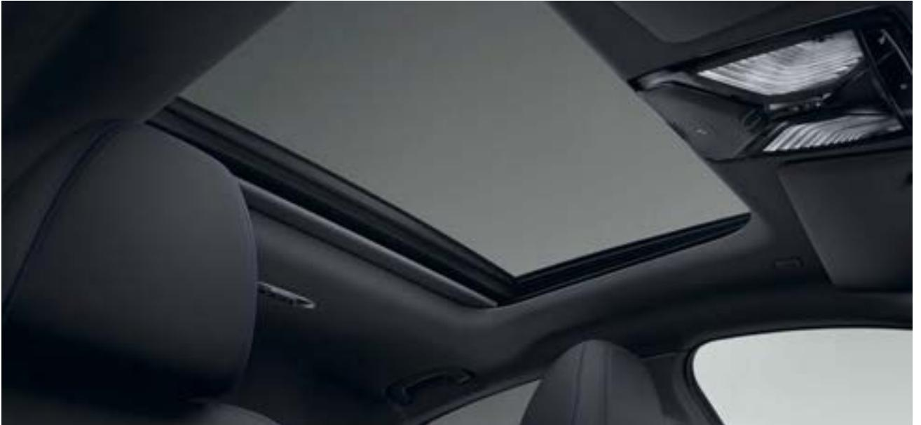
□ Das Glasdach mit Schiebe- und Hebefunktion, elektrisch verschiebbarem Innenhimmel, Einklemmschutz sowie Komfortöffnung und -schließung ermöglicht einen individuell regulierbaren Luftstrom und damit ein angenehmes Klima im Innenraum. Der integrierte Windabweiser verhindert Zugluft im Innenraum und sorgt für geringere Windgeräusche.
