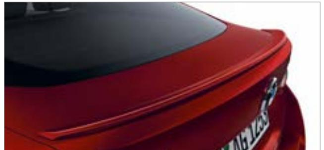
□ Der M Heckspoiler<sup>1,2</sup> in Wagenfarbe betont die sportliche Silhouette des Fahrzeugs und reduziert den unerwünschten Auftrieb. Durch die Erzeugung von Abtrieb an der Hinterachse verleiht er dem Fahrzeug damit noch mehr Fahrstabilität.
