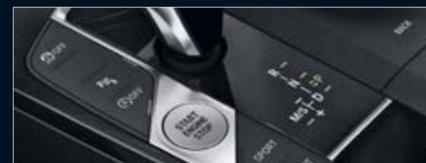
□ Maximal aus dem Stand beschleunigen – mit der **Launch Control des 8-Gang Steptronic Sport Getriebes** eine leichte Übung. Einfach auf Wählhebelposition „S“ kurz die DSC-Taste drücken und bei betätigter Bremse das Gaspedal voll durchtreten. Lösen Sie nun die Bremse, beschleunigt Ihr BMW maximal am Traktionslimit – ganz in Einklang mit Ihrem Puls.
