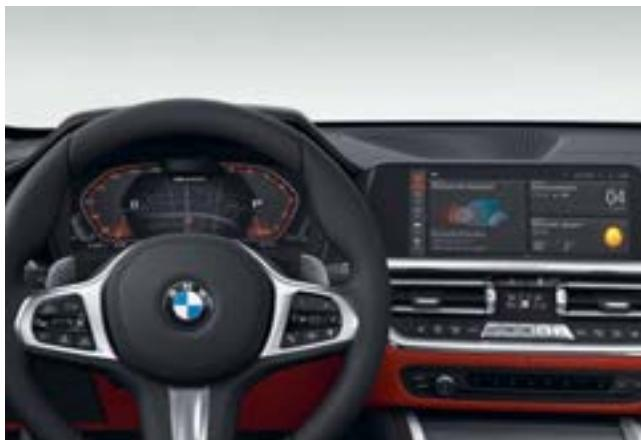
□ Das BMW Live Cockpit Professional mit Navigationsfunktion beinhaltet einen hochwertigen Anzeigenverbund, bestehend aus einem per Touch bedienbaren hochauflösenden 10,25" großen Control Display und einem volldigitalen 12,3" großen Instrumentendisplay. Das BMW Operating System 7 kann u. a. über den BMW Controller bedient werden.
