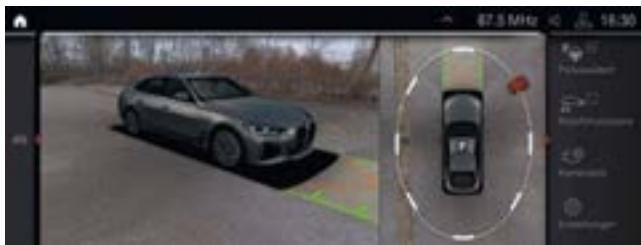
□ Der Parking Assistant Plus<sup>1</sup> erleichtert das Parken und Rangieren des Fahrzeugs. Er umfasst u. a. das Surround-View-System mit Top View, Panorama View und Remote 3D View sowie eine seitliche Einparkhilfe, die Notbremsfunktion Active Park Distance Control, den Parkassistenten mit Längs- und Querführung und den Rückfahrassistenten.
