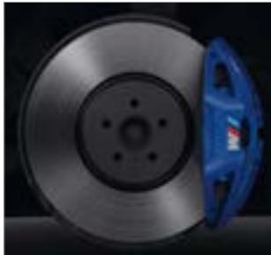
□ Die leistungsstarke M Sportbremse<sup>1,2</sup> zeichnet sich durch große Bremsscheiben und exklusive in Blau metallic lackierte Bremssättel mit M Schriftzug aus.
