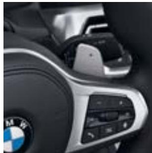
■ Das 8-Gang Steptronic Sport Getriebe ermöglicht sehr sportliche Gangwechsel. Sowohl automatisch als auch manuell per Schaltwippen bzw. Wählhebel.
