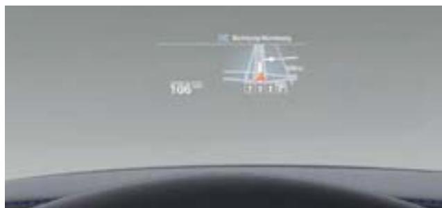
□ Das große vollfarbige BMW Head-Up Display<sup>2</sup> blendet per optischer Projektion für die Fahrt relevante Daten in Ihr Sichtfeld ein und steigert damit die Konzentration auf das Fahrgeschehen. So werden hier ausstattungsabhängig die aktuelle Geschwindigkeit, Navigationshinweise, die Speed Limit Info inkl. Überholverbotsanzeige und Telefon- und Entertainmentlisten angezeigt.
