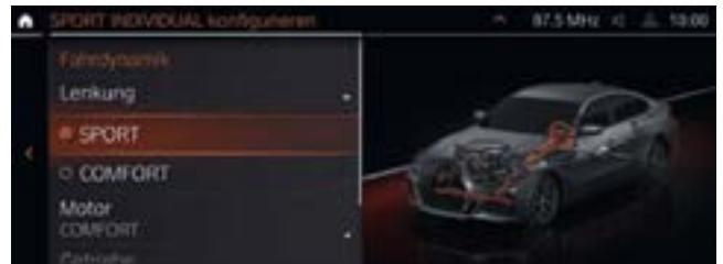
□ Die Variable Sportlenkung<sup>2</sup> mit Servotronic sorgt für ein direktes und agiles Fahrverhalten bei geringerem Lenkaufwand. Sie reagiert mit unterschiedlichen Lenkübersetzungen auf den Lenkradeinschlag. Dabei verbessert sie das Handling bei sportlicher Fahrweise und reduziert den Lenkaufwand beim Einparken und Abbiegen.
