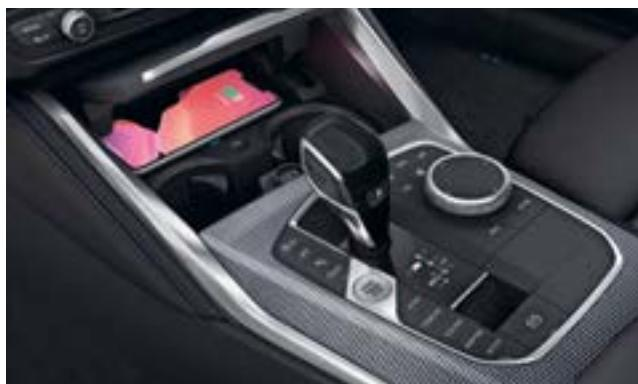
□ Die Telefonie mit Wireless Charging<sup>1</sup> umfasst eine Ladeschale mit drahtloser Ladefunktion und ein zweites Mikrofon für eine bessere Freisprechqualität bei Ihnen und Ihrem Beifahrer. Eine zusätzliche Antennenanbindung sorgt für besseren Mobilfunkempfang. Per Bluetooth lassen sich zwei Mobiltelefone und ein Audioplayer zugleich verbinden. Dazu kommt eine WLAN Hotspot Vorbereitung.
