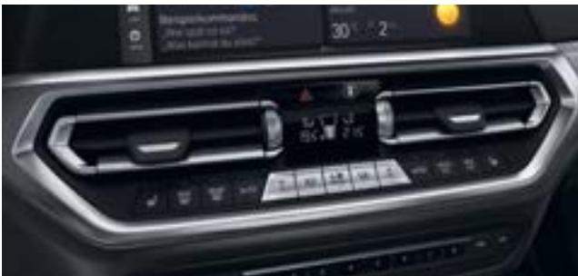
■ Die Klimaautomatik mit 3-Zonenregelung sowie automatischer Temperaturregelung können Sie und Ihr Beifahrer sowie die Passagiere im Fond getrennt regulieren. Enthalten sind die Automatische Umluft Control (AUC), ein Mikroaktivkohlefilter, ein Beschlag- und Solarsensor sowie Fondausströmer mit einem Digitaldisplay.
